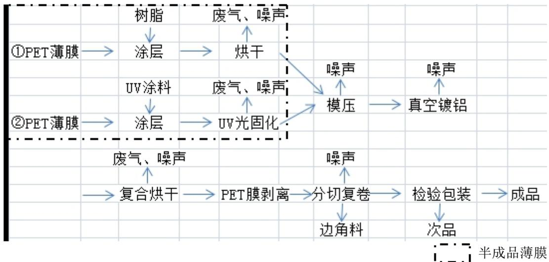
图 2.2-1 项目生产工艺流程图
